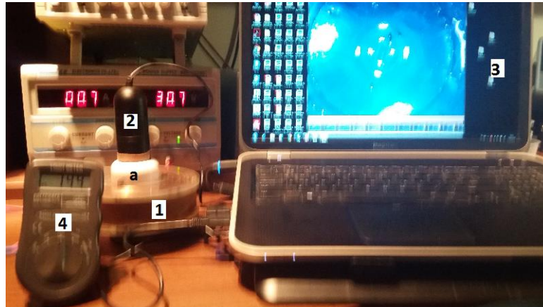
Fig.4. Fotografie echipament citire si vizualizare radiografii radiologice: 1, suport filme radiologice; 2, microscop digital; 3, unitate de calcul; 4, luxmetru; a, mansoa din cauciu siliconic.
